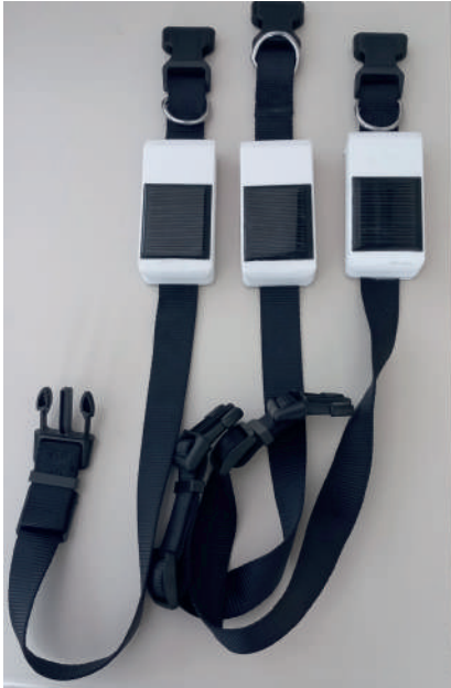
Collari GPS/LoRA predisposti per il monitoraggio di animali al pascolo (prototipi OMEGA)
