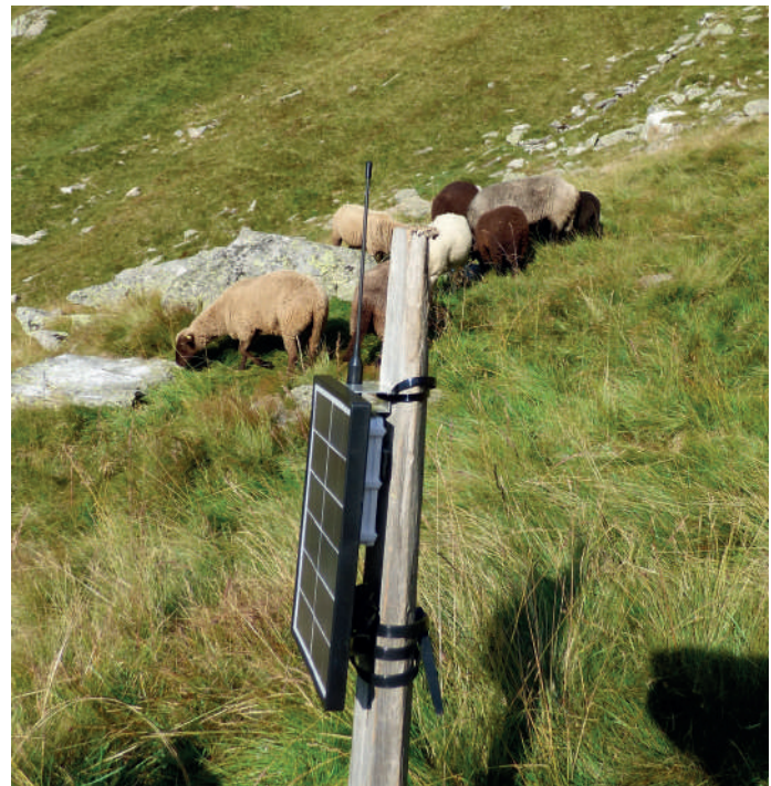
Nodo/Gateway LoRA con pannello solare per la raccolta e la trasmissione dei dati dai collari GPS
