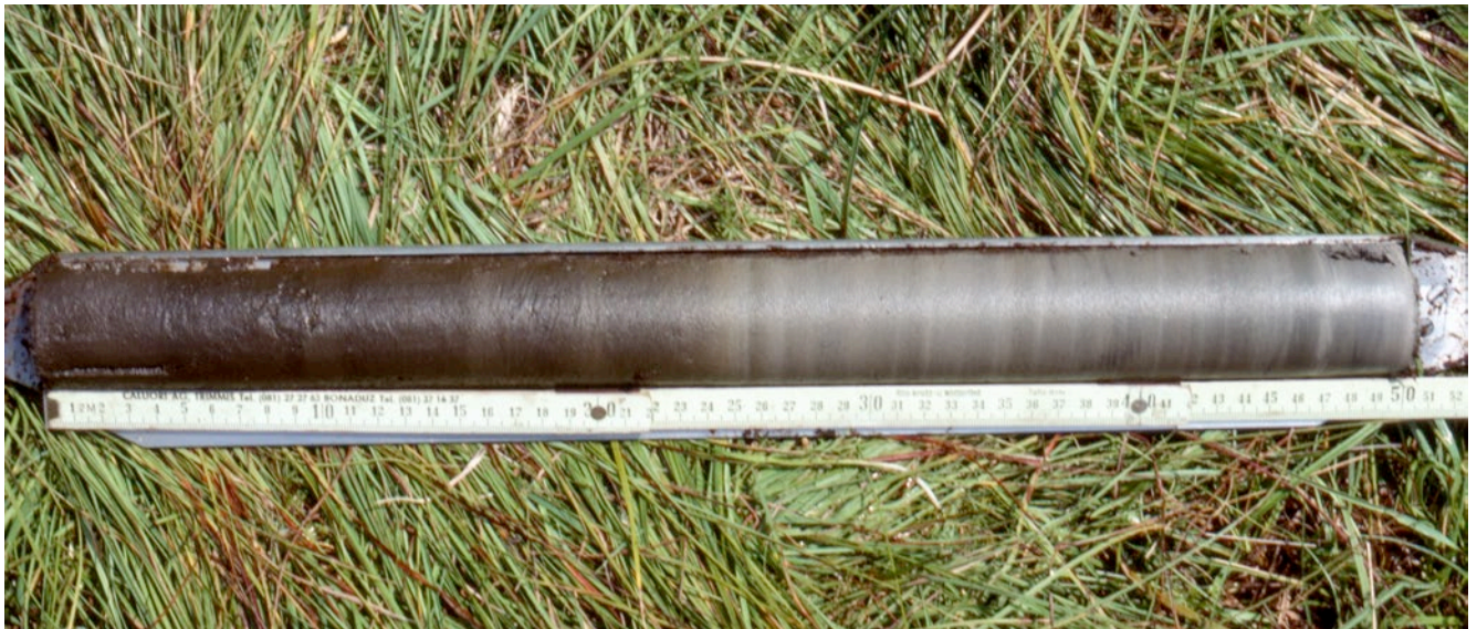
Abb. 5: Bohrkern aus dem Oberfenner Moor aus 500–550 cm Tiefe (Bohrgerät: Russischer Torfbohrer) mit der Grenze Tongyttja (graue Tone und Silte, rechts) / stark zersetzter Torf (braune Torf-Abfolge, links). Diese Sedimentgrenze in 525 cm Tiefe markiert die Grenze Späteiszeit / Beginn Holozän (Jüngere Dryas / Präboreal bzw. LPAZ 5/6) und entspricht etwa der Zeitmarke von 11.600 kalibrierte Kalenderjahre vor heute. (Foto: Conradin A. Burga, 10. August 1988)
